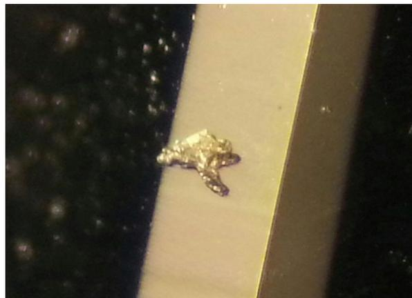
180x Vergrößerung: 2-Phasen Siliziumoxyd Mineraleinschluss
